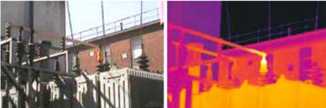
Figura N° 4. Detección de zonas sobrecalentadas por alta resistencia eléctrica en una subestación transformadora.
